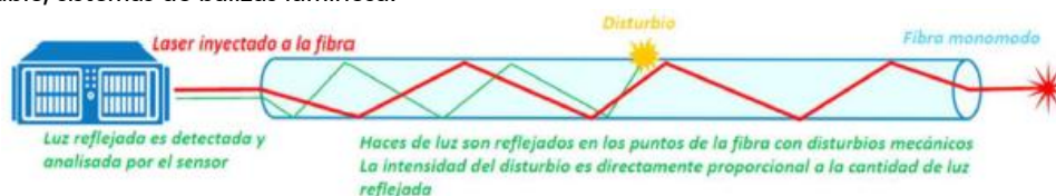
Figura 17. Señalización dinámica inteligente: detección mediante fibra óptica. Esquema de funcionamiento de la fibra. Tecnologías para la detección de fauna en carreteras. (Carlos del Brío, 2024)
