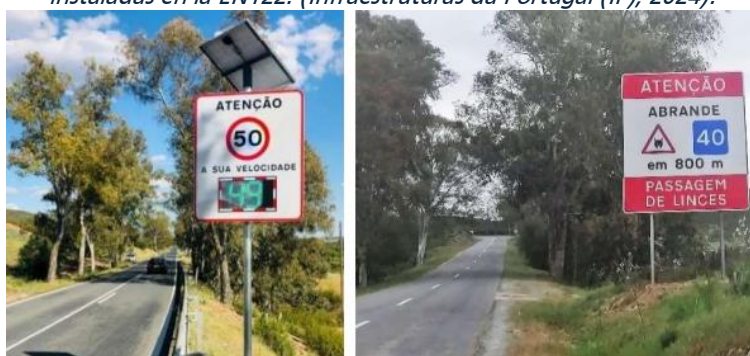
Figura 150. Paneles electrónicos de control de velocidad en la EN122 y paneles con señales de lince ibérico y recomendaciones sobre límites de velocidad en la ER267. (Infraestruturas da Portugal (IP), 2024).
