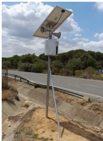
Figura 25. Reducción de velocidad: por detección de animal mediante sensores infrarrojos y cámaras termográficas (Ciencias Ambientales, 2023).
