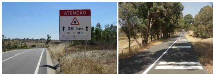
Figura 149. Señales de advertencia de peligro específicas para el lince ibérico (izquierda) y bandas reductoras de velocidad (derecha) instaladas en la EN122. (Infraestruturas da Portugal (IP), 2024).
