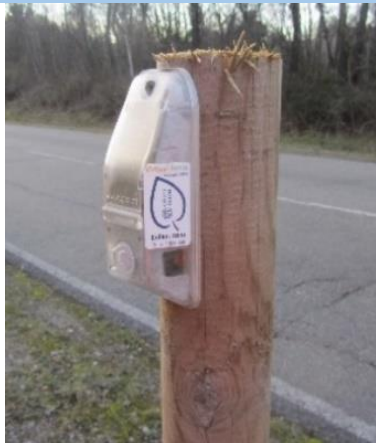
Figura 56. Vallado virtual activado por sensor lumínico. (Principado de Asturias).
