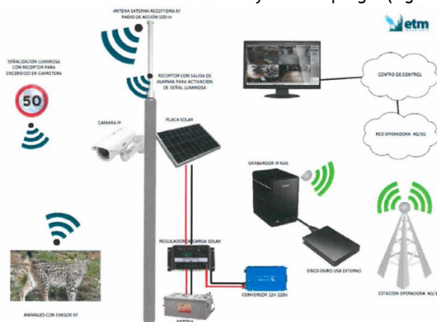
Figura 15. Esquema de funcionamiento de la señalización dinámica inteligente: detección mediante radioseguimiento. (Ministerio de Transportes y Movilidad Sostenible. Dirección General de Carreteras, 2021).
