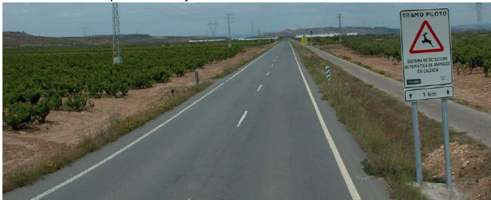
Figura 21. Señalización dinámica inteligente: detección mediante visión artificial. Tramo Piloto. (Gobierno de La Rioja, 2023).
