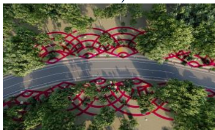
Figura 57. Vallado virtual activado por sensor lumínico. Esquema de funcionamiento. (Grupo EULEN Medio Ambiente).
