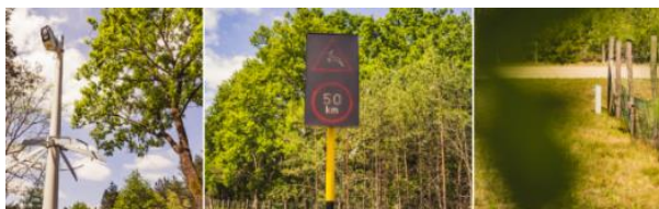
Figura 123. Sistemas de alerta de fauna a los conductores. Bélgica. (Agentschap Wegen & Verkeer).
