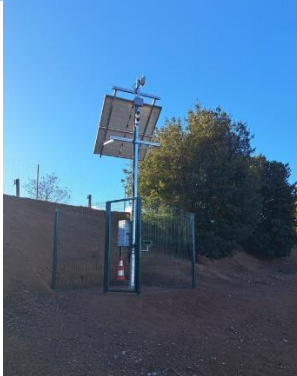
Figura 35. Disuadores ultrasónicos dotados con cámaras de detección mediante análisis IA. (Generalitat de Catalunya)
