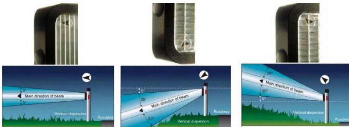
Figura 31. Detalle de los diferentes ahuyentadores ópticos en función de la pendiente del terreno. (Junta de Comunidades de Castilla-La Mancha).
