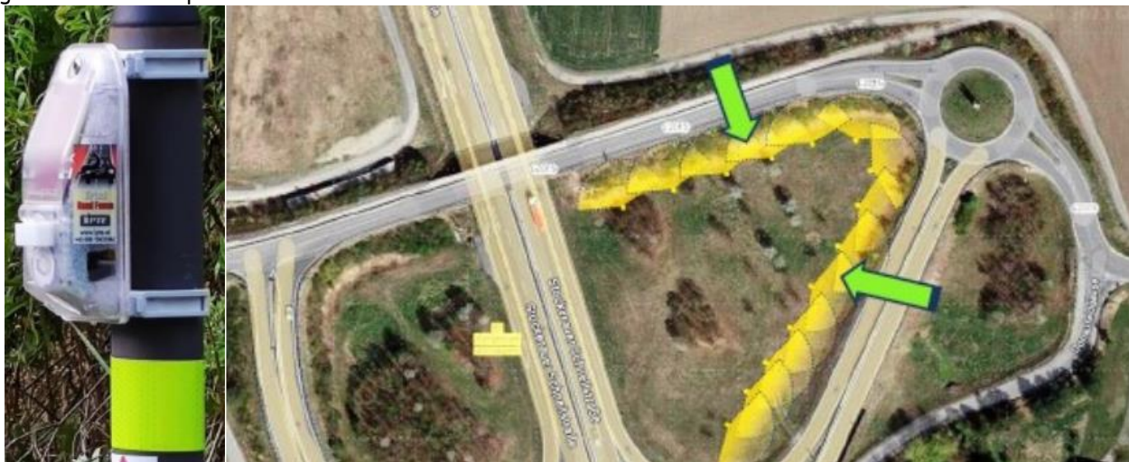
Figura 59. Vallado virtual activado por sensor térmico. (Grupo EULEN Medio ambiente, 2024).
